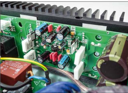
*Das Endstufenmodul arbeitet mit vier kräftigen bipolaren Transistoren pro Kanal*
