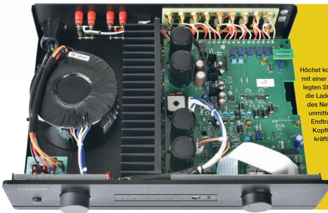
Höchst kompakte Bauweise mit einer kräftig ausgelegten Stromversorgung, die Ladekondensatoren des Netzteils sitzen unmittelbar neben den Endtransistoren. Der Kopfhörerausgang ist kräftig ausgelegt.
